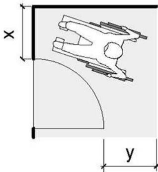
Die Bedingungen  $x = \text{min. } 0,60 \text{ m}$  /  $x + y = \text{min. } 1,20 \text{ m}$  sind einzuhalten, auch wenn die Türen automatisiert sind
